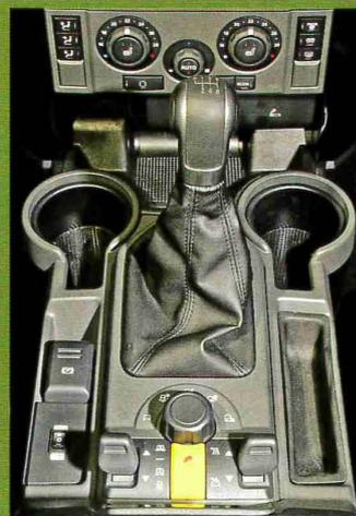
**UMSCHALTEN** Steuerzentrale für die Luftfederung
