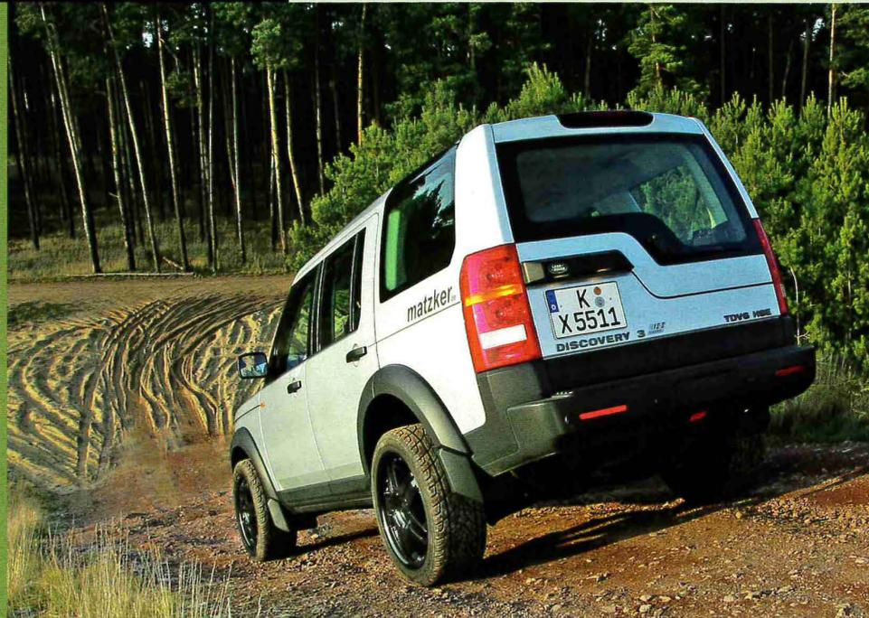
**AUSSTRECKEN** Das Umbaufahrwerk bringt bis zu 270 Millimeter Bodenfreiheit
