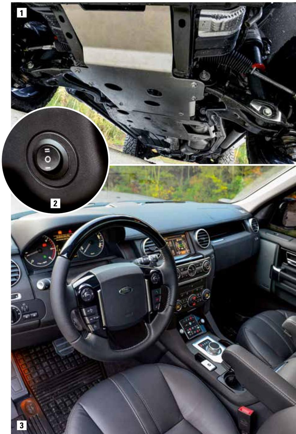
1 | Für Rutschpartien: Die Antriebstechnik wird von sechs Millimeter starken Aluplatten geschützt.
