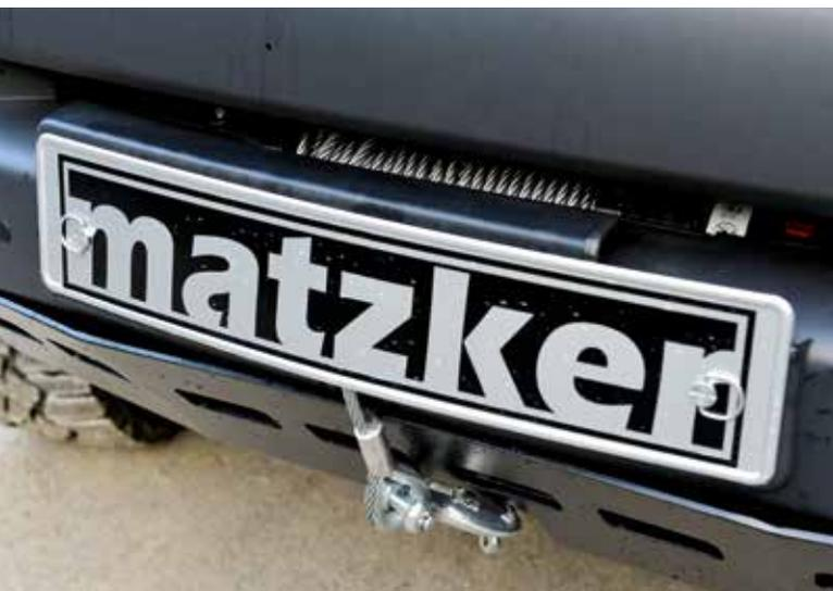
Elegant hinter der Stoßstange versteckt: Warn-Seilwinde mit 3,6 Tonnen Zugkraft und Stahlseil. Auf Wunsch auch gern stärker.
