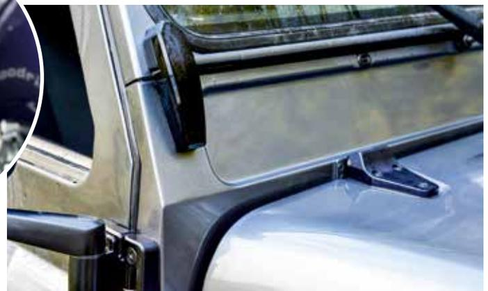
**Schwachpunkte beseitigt:** Türen und Hauben hängen an abschmierbaren Alu-Scharnieren, die Windschutzscheibe an neuen, massiven Haltern.
