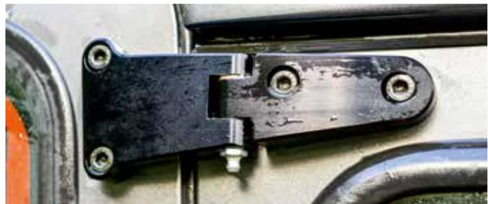
**Solide Technik:** Die Alu-Scharniere an der Hecktür halten mehr Last aus. Ihre Edelstahl-Bolzen besitzen eine Wendelnut für optimale Schmierung.
