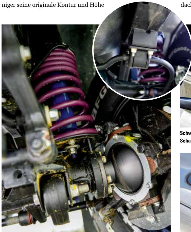
**Optimiertes Fahrwerk:** Die Federn des Matzker-Suspension-Kits arbeiten progressiv, die Stabis sind vorn weicher und härter als in der Serie.
