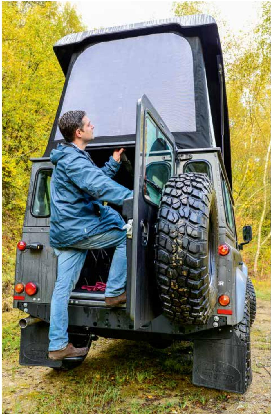
**Einfache Sache:** Das leichte Carbon-Dach wird von seitlichen Gasdruckstützen angehoben. Der Nachteil des Systems ist, dass man kein zusätzliches Gewicht aufs Dach packen kann.
