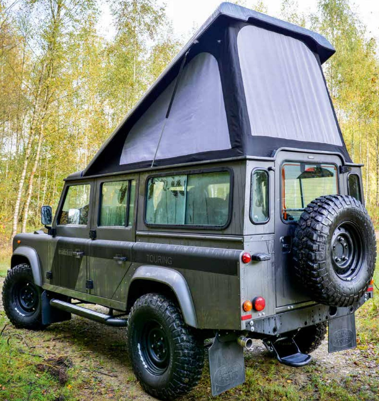
Luftige Schlafstatt: Die Textil-Seitenwände im oberen Stockwerk sind mit großzügigen Fenstern und Moskitonetzen ausgestattet.
