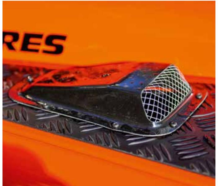
Doppelnutzen: Der Schnee bleibt draußen, dafür pustet der Fahrtwind durch den Air Duct extra viel Luft ins Lüftungsgitter auf dem rechten Kotflügel.
