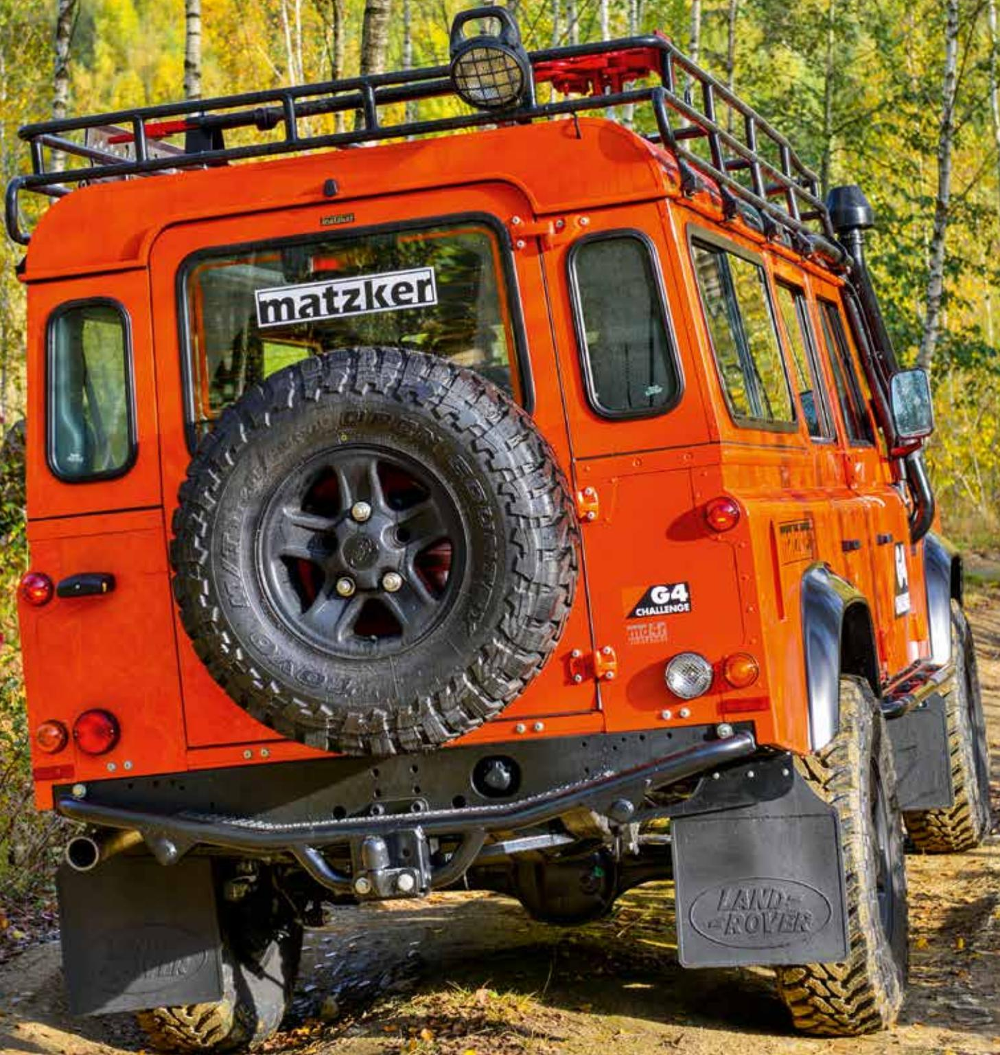
Multifunktional: Die neue Heckstoßstange aus robustem Stahl verstärkt den Rahmen und trägt auch gleich eine Anhängerkupplung.
