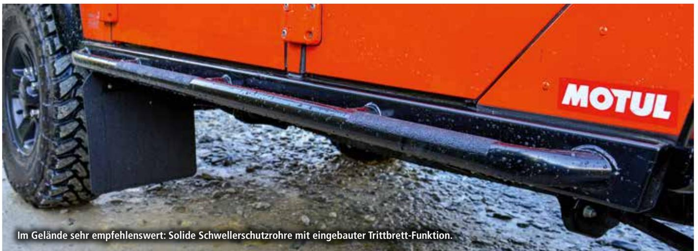
Im Gelände sehr empfehlenswert: Solide Schwellerschutzrohre mit eingebauter Trittbrett-Funktion.
