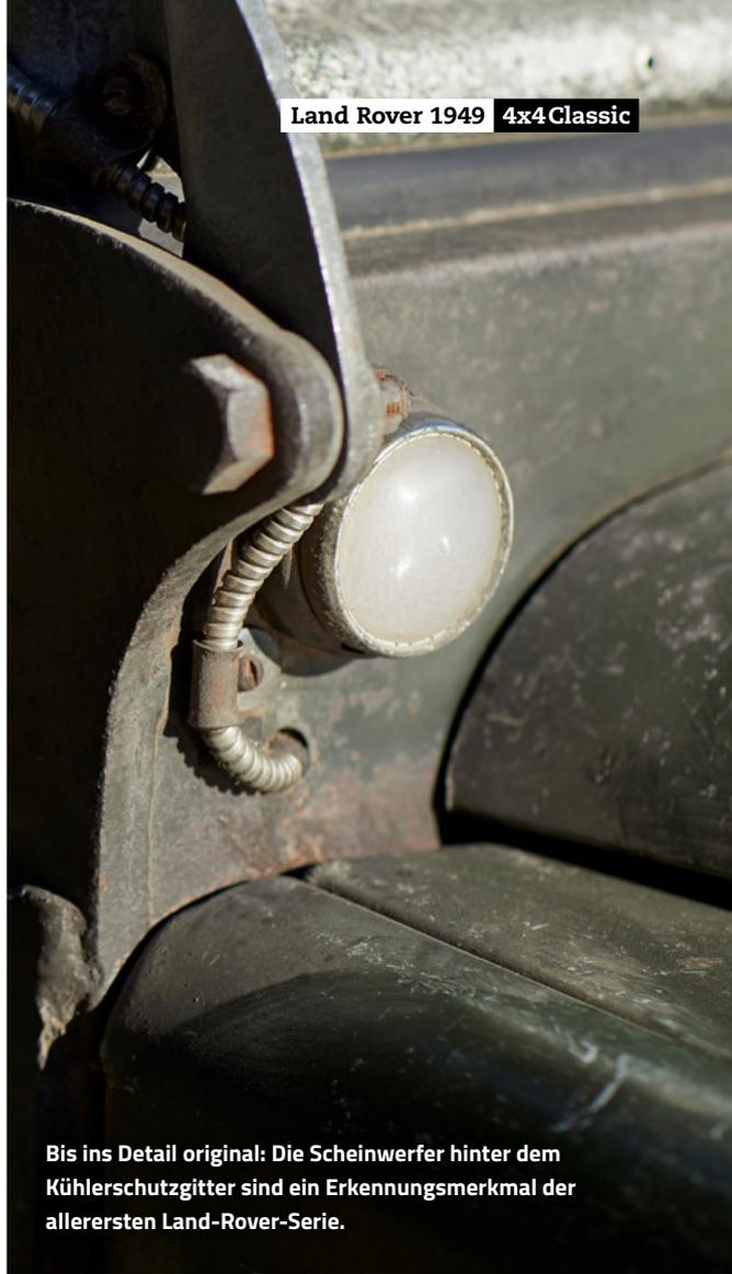
Bis ins Detail original: Die Scheinwerfer hinter dem Kühlerschutzgitter sind ein Erkennungsmerkmal der allerersten Land-Rover-Serie.
