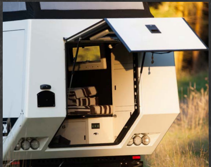
▲ HeckEinstieg: Die Klappe schwenkt Gasdruck-unterstützt auf und fungiert als Regendach. Von innen braucht es etwas Akrobatik, um sie zu schließen.
