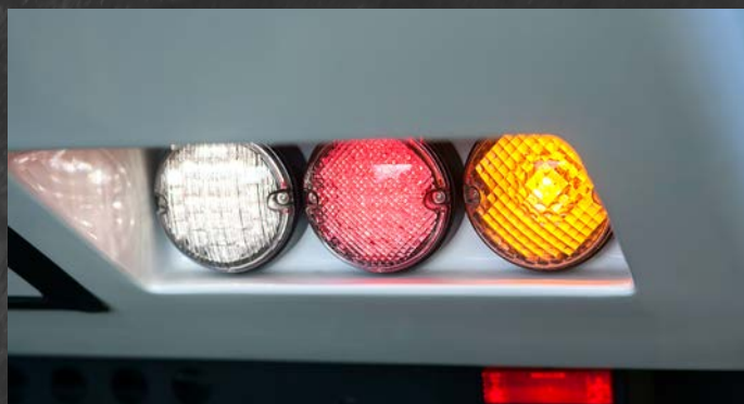
▲ Moderne Technologie: Die Rückleuchten in LED-Technik sind sehr hell und liegen in einer Aussparung der Kabine gut vor Ästen geschützt.
