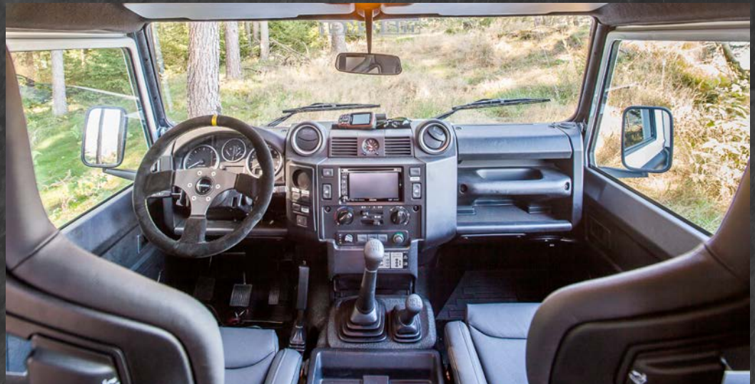
▲ Klassisch, aber komfortabel: Das Cockpit des Test-mdx wurde dezent mit Lederlenkrad, Navi in Doppel-DIN-Format und sehr guten Recaro-Ledersitzen aufgewertet. Der Durchgang in die Kabine geht über die komplette Breite.
