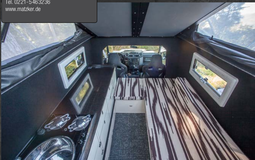
▲ Gute Raumnutzung: Mit aufgestelltem Dach bietet die Kabine im Pantrybereich ausreichend Stehhöhe. Die S4-Fenster des Herstellers Seitz besitzen Mückengitter.
