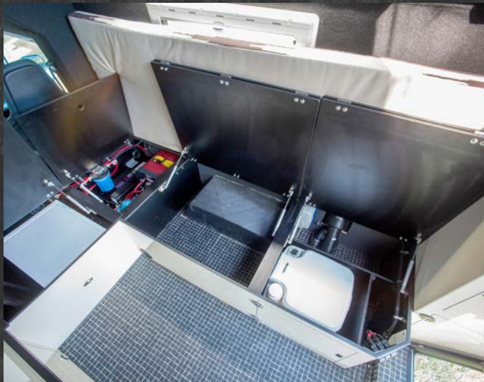
▲ Aufgeräumt: Der Stauraum unter den Polstern ist sinnvoll strukturiert, das Chemie-WC lässt sich auch aus einer Klappe direkt herausziehen.
