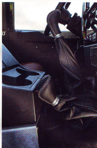
Mit Subwoofer-Unterbau wirds eng für die Schalthebel. Bitte versetzen.
