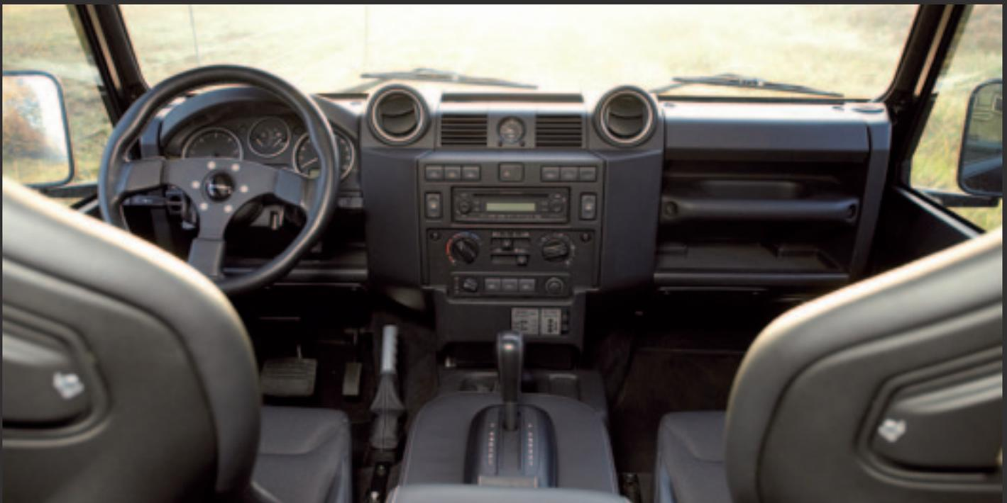
▲ Kleines Teil mit großer Wirkung: Durch das Sportlenkrad wachsen die seitliche Bewegungsfreiheit und der Raum für die Fahrerbeine.
