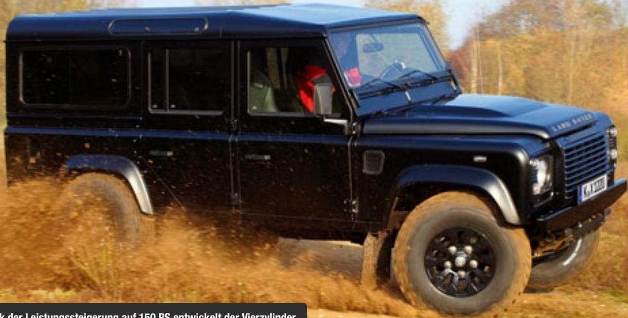
▲ Dank der Leistungssteigerung auf 150 PS entwickelt der Vierzylinder ausreichend Dampf für flotte Fahrt.
