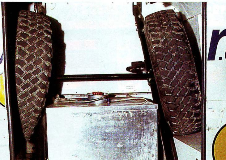
**Sicher:** Feuerschutzwand, Kevlar-Tank, zwei Ersatzreifen.
