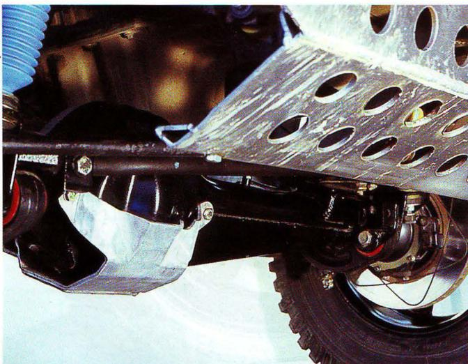
**Knackpunkt:** Ein Stein riss den Lenkstangen-Kugelkopf ab.
