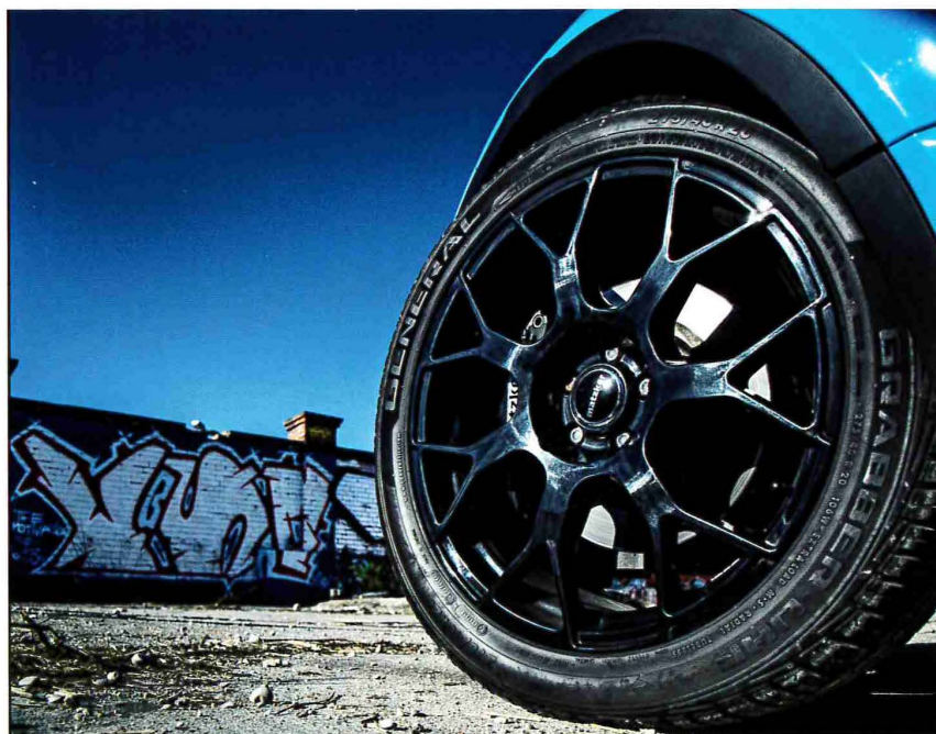
Massige Haftung: Die breiten Niederquerschnitt-Gummis im Format 275/40 R20 kleben auf der Straße.
