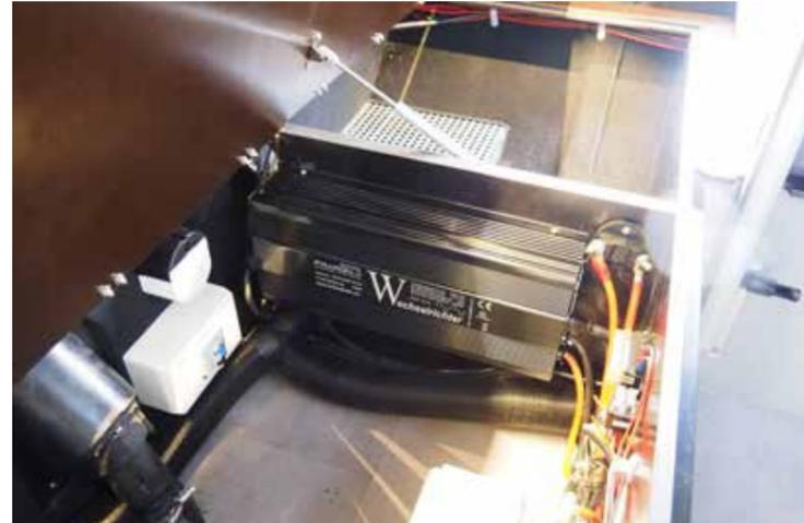
Der 220 Volt Wechselrichter liefert 550 Watt Dauerleistung.
